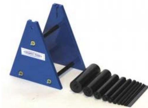
**Прибор «Изгиб»** измеряет эластичность покрытий методом изгиба вокруг цилиндрических стержней и пластин. Прибор состоит из станины с углублениями для установки стержней и набора металлических цилиндрических стержней разного диаметра и пластины. Количество испытательных цилиндрических стержней – 10 шт. Количество испытательных пластин – 1 шт.
