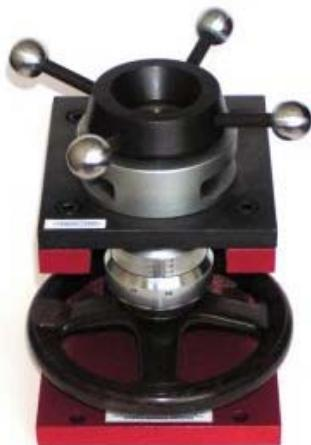
**Прибор Эриксена** измеряет прочность, эластичность и стойкость полимерных, порошковых и жидких лакокрасочных покрытий к растяжению, растрескиванию и отслаиванию от металлической поверхности изделий при их деформации, при вдавливании в матрицу на измеряемую глубину пуансона со сферическим наконечником диаметром 20 мм по ГОСТ 29309, ИСО 1520 и диаметром матрицы 27 мм (инструмент №1). Применяется с прибором Удар-Тестер.
