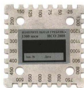
**Измерительная гребенка (калиброванный гребень)** предназначен для измерения толщины жидких лакокрасочных материалов на плоских и цилиндрических поверхностях изделий.
