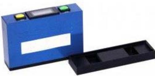
**Прибор БФ-45/0** предназначен для измерения коэффициента яркости поверхности дорожной разметки по ГОСТ Р 51256, лакокрасочных, эмалированных и других покрытий при углах освещения-наблюдения  $45^{\circ}/0^{\circ}$ , направленного светового потока в видимой области спектра с целью количественной оценки зрительного восприятия человеческим глазом степени яркости указанных покрытий. Прибор используется для определения укрывности лакокрасочных материалов по ГОСТ 8784.
