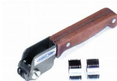
**Адгезиметр РН** измеряет адгезию покрытий методом решетчатого надреза покрытия до основания, сдвигая его вдоль поверхности изделия, на которое оно нанесено.
