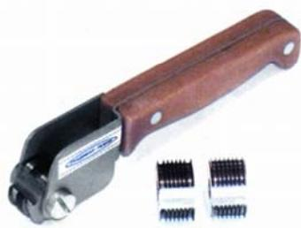
**Адгезиметр РН** измеряет адгезию покрытий методом решетчатого надреза покрытия до основания, сдвигая его вдоль поверхности изделия, на которое оно нанесено.
