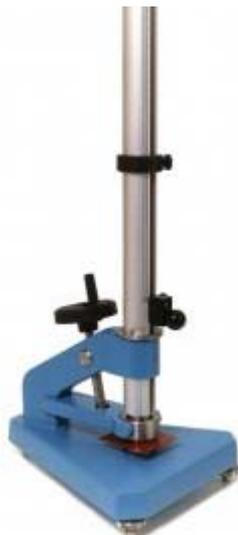
Измеритель прочности покрытий при ударе **ИПУ/ Удар-Тестер** является универсальным прибором и позволяет измерить прочность покрытий при ударе одновременно по требованиям ГОСТ 4765 и ИСО 6272, т.к. комплектуется двумя наборами ударников и матриц. Прибор снабжен механизмом прижима и фиксации образца с покрытием. Глубина проникновения ударников в основание с покрытием при проведении испытаний регулируется при помощи набора специальных шайб в диапазоне от 2 до 10 мм.
