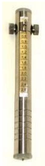
**Твердомер** быстро измеряет твердость лакокрасочных, порошковых, мастичных, пластиковых покрытий по отпечатку сферического наконечника диаметра 1 мм. Твердомер состоит из пружинного механизма для создания тарированного давления на покрытие, фиксирующего давления на покрытие механизма и индентора с диаметром сферического наконечника 1 мм.
