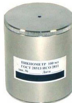
**Пикнометр** металлический вместимостью 100 мл. предназначен для определения плотности лакокрасочных материалов пикнометрическим методом по ГОСТ 28513, ИСО 2811. Материалы лакокрасочные. Метод определения плотности.
