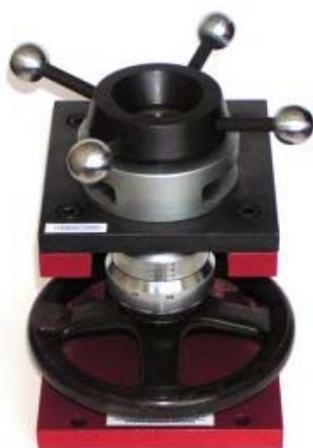
**Прибор Эриксона** измеряет прочность, эластичность и стойкость полимерных, порошковых и жидких лакокрасочных покрытий к растяжению, растрескиванию и отслаиванию от металлической поверхности изделий при их деформации, при вдавливании в матрицу на измеряемую глубину пуансона со сферическим наконечником диаметром 20 мм по ГОСТ 29309, ИСО 1520 и диаметром матрицы 27 мм (инструмент №1). Применяется с прибором Удар-Тестер.
