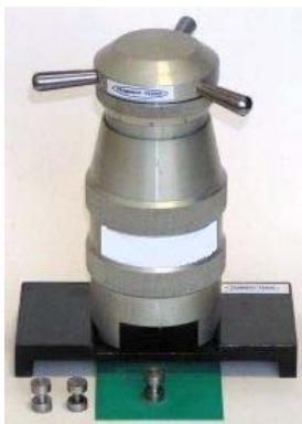
**Адгезиметр ОР** измеряет усилие отрыва – адгезию полимерных, порошковых, жидких лакокрасочных покрытий, дорожной разметки, клеев, паркетных лаков, грунтовок, шпаклевок и др. покрытий по ИСО 4624.
