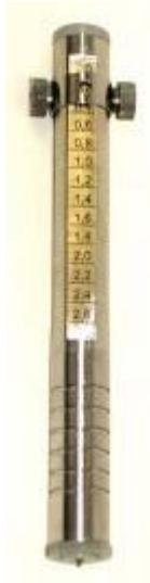
**Твердомер** быстро измеряет твердость лакокрасочных, порошковых, мастичных, пластиковых покрытий по отпечатку сферического наконечника диаметра 1 мм. Твердомер состоит из пружинного механизма для создания тарированного давления на покрытие, фиксирующего давления на покрытие механизма и индентора с диаметром сферического наконечника 1 мм.
