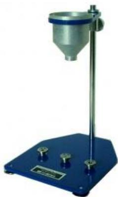
**Вязкозиметр ВЗ - 246** предназначен для быстрого определения условной вязкости (времени истечения) лакокрасочных материалов или относящихся к ним продуктов - ньютоновских или приближающихся к ним жидкостей в соответствии со стандартом ГОСТ 9070-75.
