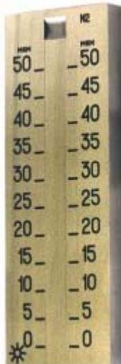
**Гриндометр/Клин** предназначен для анализа размеров частиц и агломератов при определении степени перетира при испытании пигментированных лакокрасочных материалов и масляных красок в различных диапазонах измерения.
