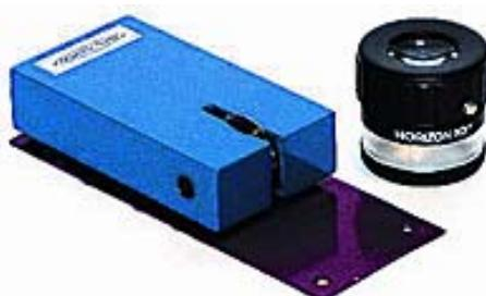
**Прибор Бухгольца** измеряет твердость покрытий методом вдавливания индентора Бухгольца в покрытие. Твердость покрытия по Бухгольцу определяется по величине длины отпечатка от вдавливания индентора. Измерение длины вдавливания индентора прибора производится специальной измерительной лупой с увеличением  $6 - 10^x$  и точностью измерения длины не более 0,1 мм. Результат испытаний выражается в виде функции обратной величине длины вдавливания.
