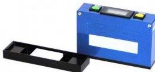
**Прибор блескомер БФ-5** предназначен для измерения блеска поверхности лакокрасочных, эмалированных и других покрытий при углах освещения – наблюдения  $20^{\circ}/20^{\circ}$ ,  $45^{\circ}/45^{\circ}$ ,  $60^{\circ}/60^{\circ}$  направленного светового потока в видимой области спектра с целью количественной оценки зрительного восприятия человеческим глазом степени блеска указанных покрытий.
