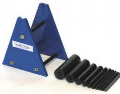
**Прибор «Изгиб»** измеряет эластичность покрытий методом изгиба вокруг цилиндрических стержней и пластин. Прибор состоит из станины с углублениями для установки стержней и набора металлических цилиндрических стержней разного диаметра и пластины. Количество испытательных цилиндрических стержней – 10 шт. Количество испытательных пластин – 1 шт.
