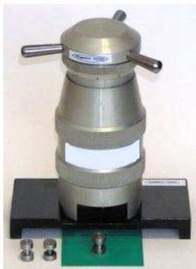
**Адгезиметр ОР** измеряет усилие отрыва – адгезию полимерных, порошковых, жидких лакокрасочных покрытий, дорожной разметки, клеев, паркетных лаков, грунтовок, шпаклевок и др. покрытий по ИСО 4624.
