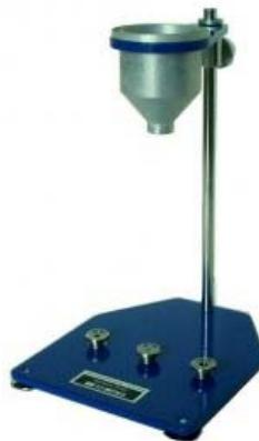
**Вискозиметр В3 - 246** предназначен для быстрого определения условной вязкости (времени истечения) лакокрасочных материалов или относящихся к ним продуктов - ньютоновских или приближающихся к ним жидкостей в соответствии со стандартом ГОСТ 9070-75.
