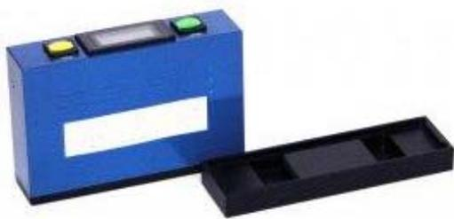
**Прибор БФ5-45/0** предназначен для измерения коэффициента яркости поверхности дорожной разметки по ГОСТ Р 51256, лакокрасочных, эмалированных и других покрытий при углах освещения-наблюдения  $45^{\circ}/0^{\circ}$ , направленного светового потока в видимой области спектра с целью количественной оценки зрительного восприятия человеческим глазом степени яркости указанных покрытий. Прибор используется для определения укрывности лакокрасочных материалов по ГОСТ 8784.
